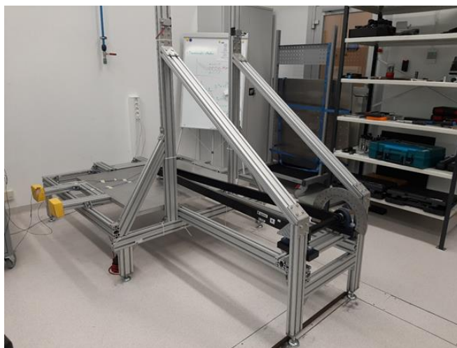
Joonis 2. Tartu Ülikooli Tartu observatooriumi põrutuskindluse katsetamise süsteem Allikas: Kristin Kandelini erakogu, 2020.
