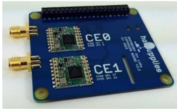
Joonis 9. Raspberry Pi LoRa raadiosidemoodul.
