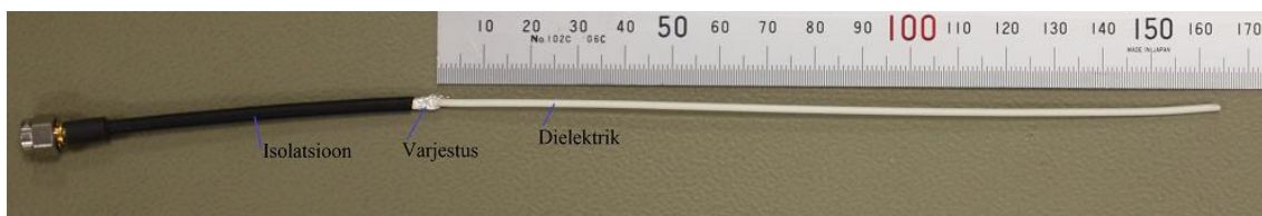
Joonis 12. Koaksiaalkaablist antenni näide.
