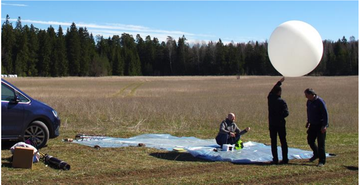
Joonis 4. Heeliumiga täidetud palli külge sondi (valge vahtplastist karp) ja langevarju (rohelise- ja mustalaiguline kangas) sidumine vahetult enne lendulaskmist.
