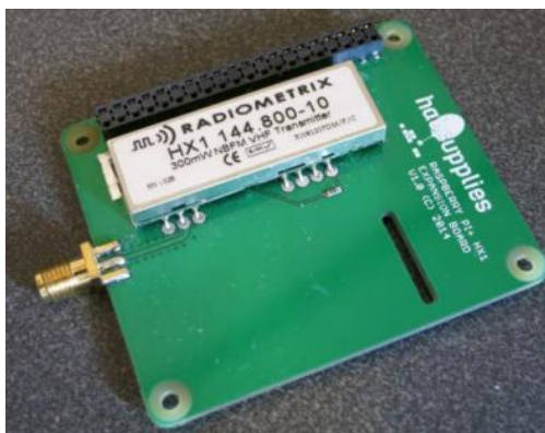
Joonis 8. Raspberry Pi laiendusplaat HX1 (APRS saatjamoodul).
