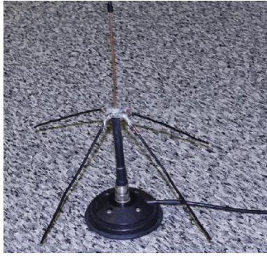
Joonis 21. Vastuvõtuantennide näited. Vasakul on veerandlaineline antenn magnetjalal, paremal on Yagi suundantenn
