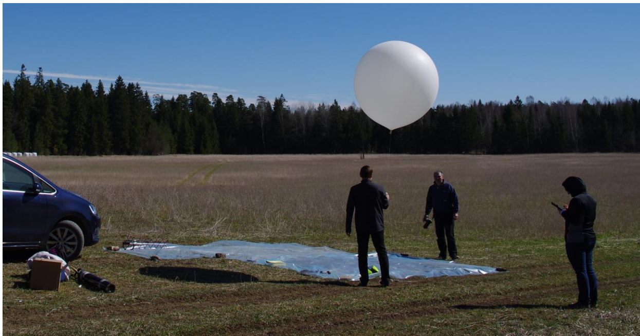
Joonis 3. Õhupalli heeliumiga täitmine Märjamaa lähistel.
