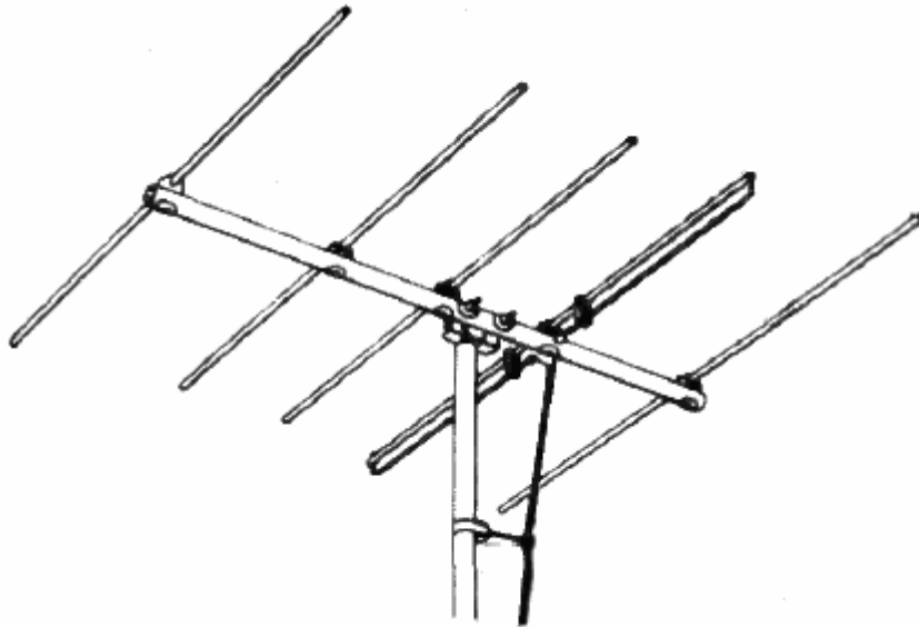
Joonis 7. Yagi antenn 5 elemendiga.
